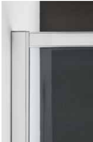
_Profilo di compensazione laterale, per compensare la misura del box quando la parete non si presenta in bolla/ Side compensation profile. To compensate forenclosures in non-standard sizes.
